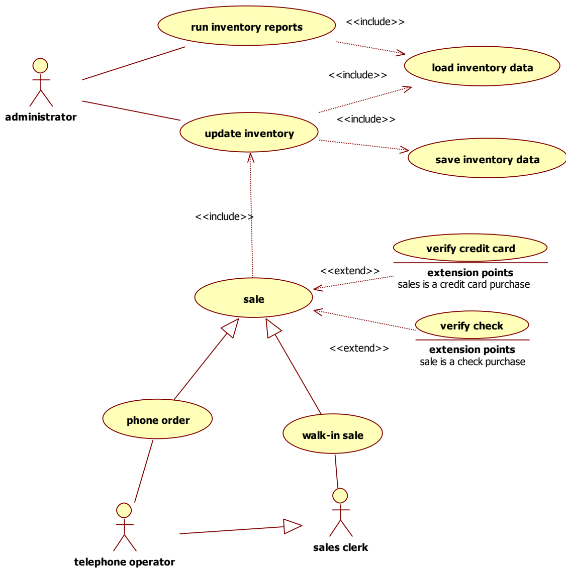
(그림2-11) Use case diagram의 사용 예
